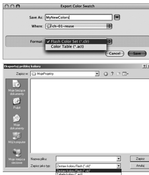
Rysunek 2.16. Chcąc zapisać paletę kolorów w celu ponownego jej użycia, skorzystaj z okna Eksportuj próbkę koloru i z rozwijanej listy Zapisz jako typ (Windows, rysunek na dole) lub Save As (Mac, rysunek na górze) wybierz pozycję Zestaw koloru Flash
